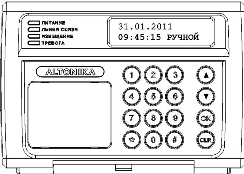
Рисунок 1 – Вид на переднюю панель ПД
